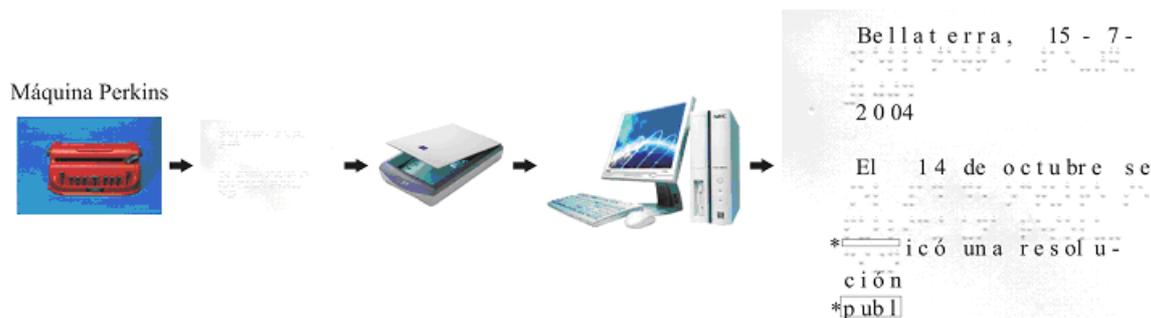
**Figura 1.** a) Sistema de traducción Braille-Vista. b) Resultado de la traducción.
